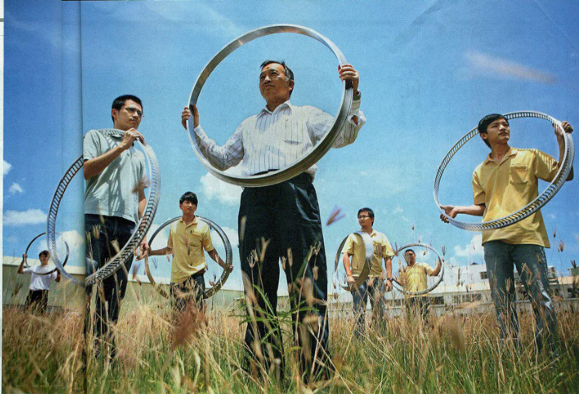
▶ 流著航太工程與機械機具雙重基因的混血企業寶一科技，董事長曾煥明與員工手上拿著呼拉圈大小、用以固定引擎葉片的鋁合金零件，是波音七三七不可少的引擎零件。
